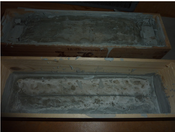
Figuur 20: De doos en het deksel, nadat ze gedroogd hadden. Een grote scheur in het deksel is te zien.
