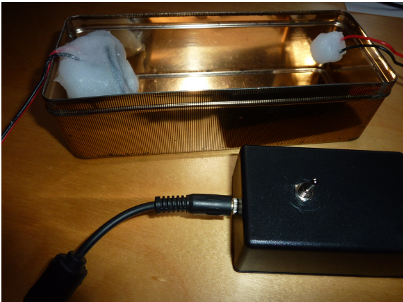
Figuur 24: Microfoon en speaker in het koekblik dat als ruimte zal dienen.
