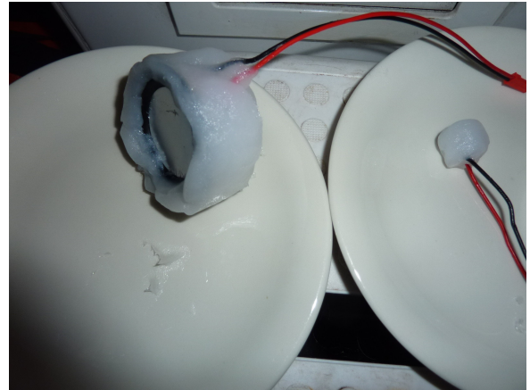
Figuur 23: Microfoon en speaker hebben een siliconenomhulsel gekregen.
