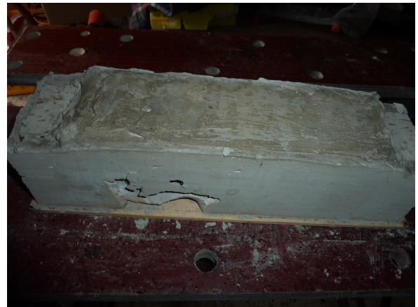
Figuur 21: Het beton heeft de mal niet overal goed gevuld waardoor zwakke plekken en scheuren zijn ontstaan. Daardoor is het beton niet goed te gebruiken
