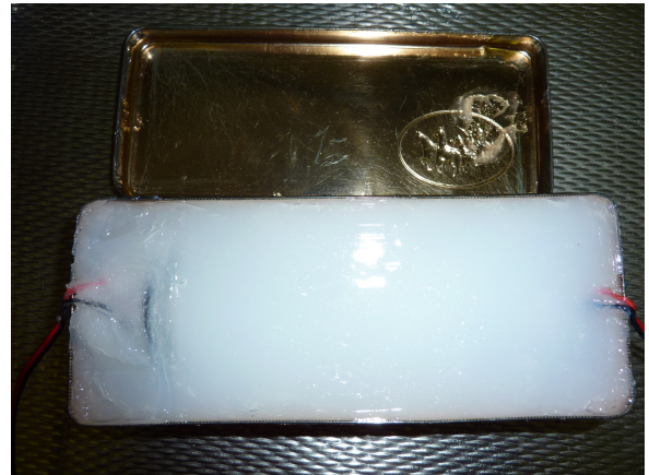
Figuur 25: De ruimte is volledig gevuld met gel.
