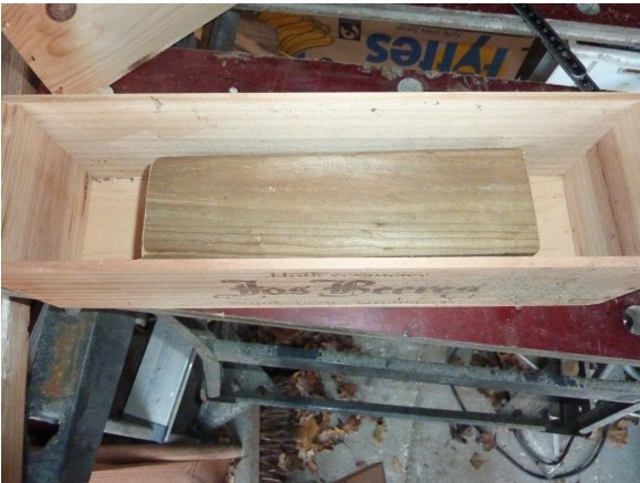
Figuur 18: Dit is de mal waar het beton in werd gegoten.
