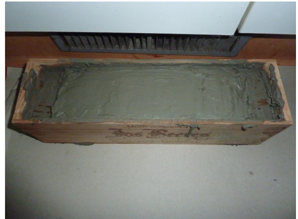
Figuur 19: Beton in de mal gedaan. Aan beide uiteinden is een extra stuk hout toegevoegd om beton te besparen.
